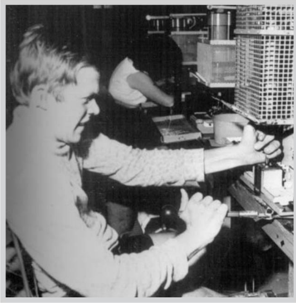
Howard Davidson vận hành máy ép tự động. Lưu ý rằng đòn bẩy đã được mở rộng để vận hành xe lăn của anh ấy
