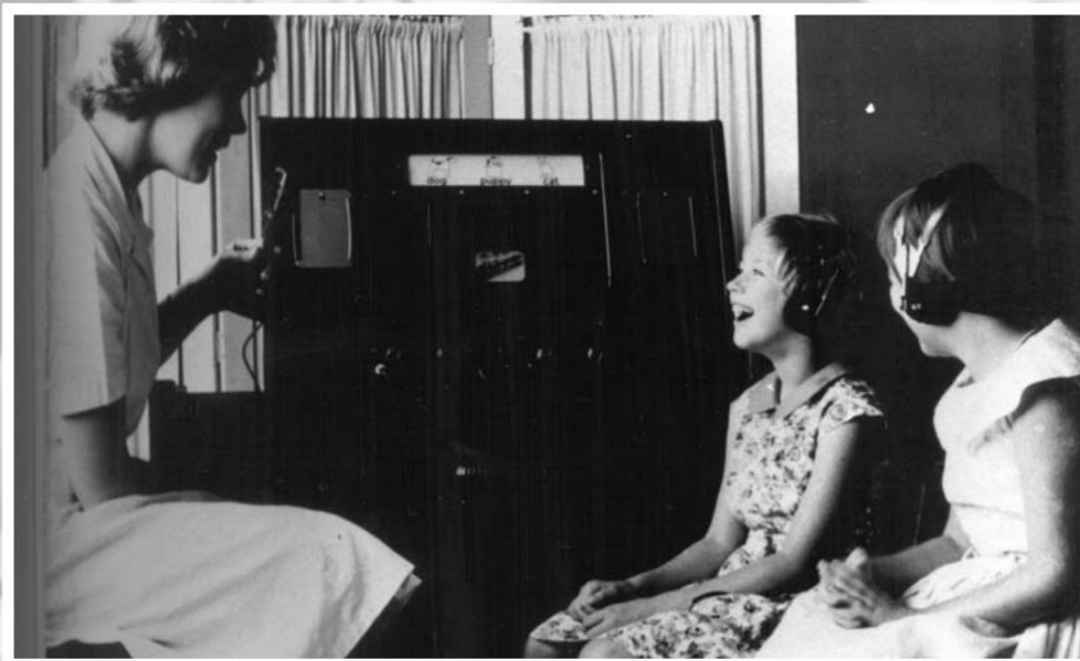
Chromovox là một hộp TV cơ học. Nó có hình ảnh và thiết kế trên một cuộn băng giấy 4 inch và nó được khuếch đại cho những người 'khiếm thính' của chúng tôi và được trang bị đèn màu cho 'có' hoặc 'không' và kết hợp với máy ghi âm nó được sử dụng cho trẻ em khiếm thính.
